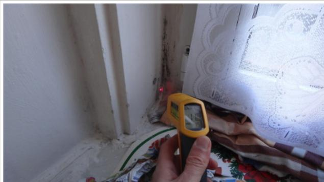
Fig. 7: Küche Fenster: niedere Oberflächentemperaturen und Schimmelbefall
